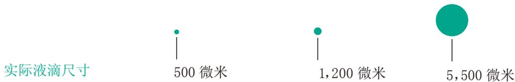
液体特性、喷嘴流量、喷射压力和喷雾角度都会对液滴的大小产生影响。喷雾压力较低时产生较大的液滴，而喷雾压力较高时产生较小的液滴。在同一种喷雾类型中，最小流量的喷嘴产生最细的喷雾液滴，最大流量的喷嘴则产生最粗的喷雾液滴。
